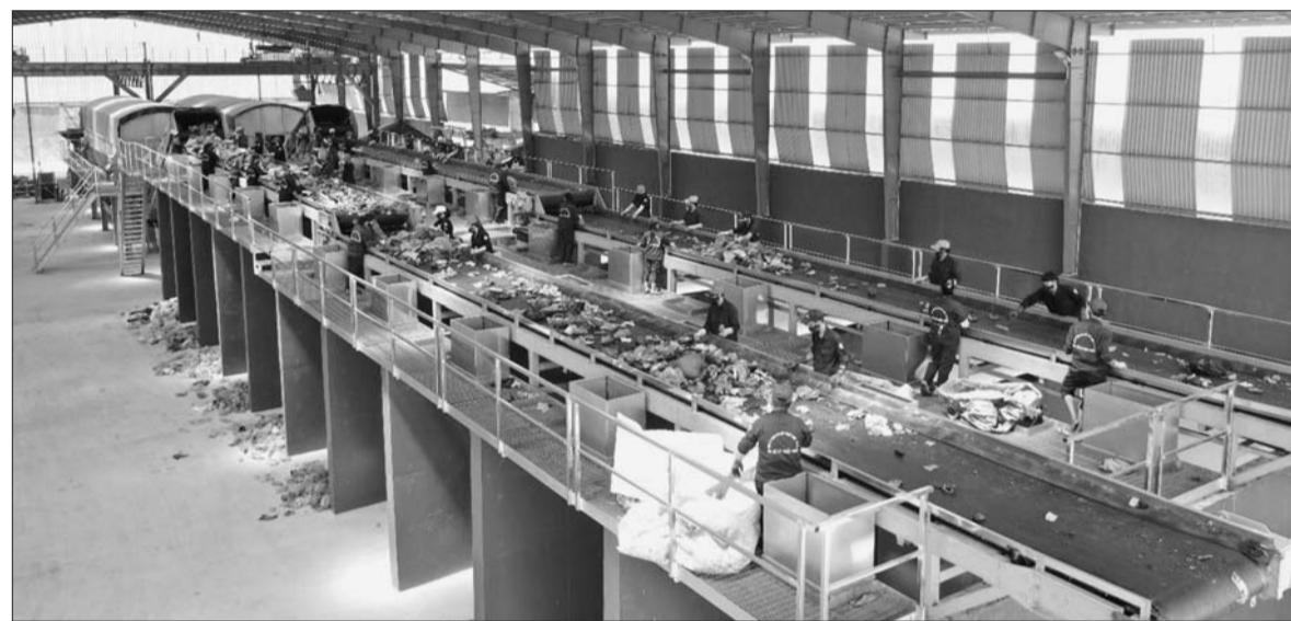
Dây chuyền phân loại rác tại Khu liên hợp xử lý chất thải Nam Bình Dương Ảnh: Báo Bình Dương
